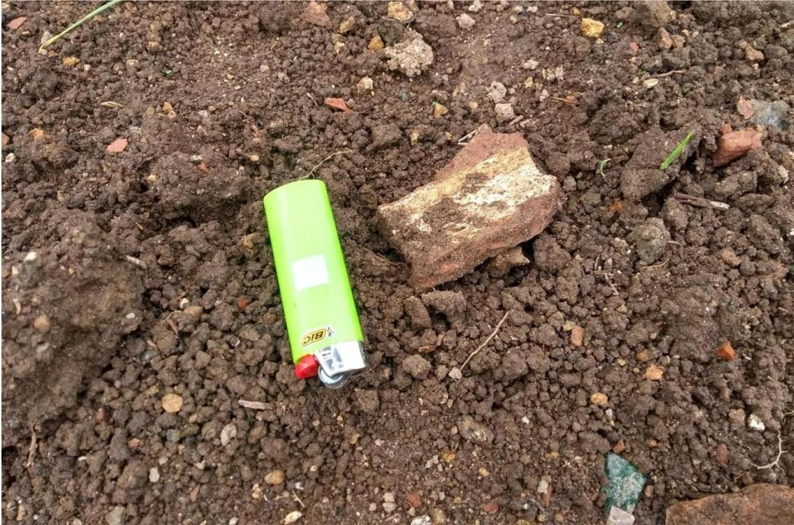
**Figura 59:** Fragmento de telha colonial com restos de argamassa feita com conchas. Também é possível visualizar fragmentos de telha e um caco de vidro (verde). Foto autoral, 23/09/2020
