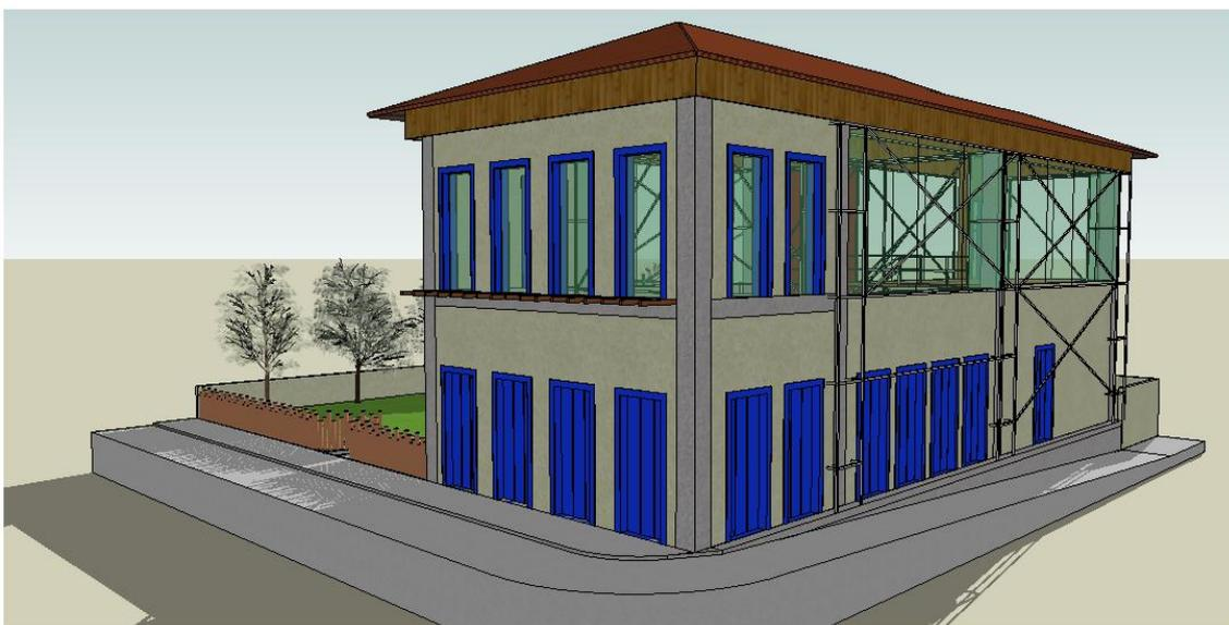
**Figura 56:** Estudo de Milton Barros de outra perspectiva. Nota-se as janelas de vidro para aproveitar a iluminação do ambiente, e, a estrutura metálica para segurar os pilares impactados e originais.
