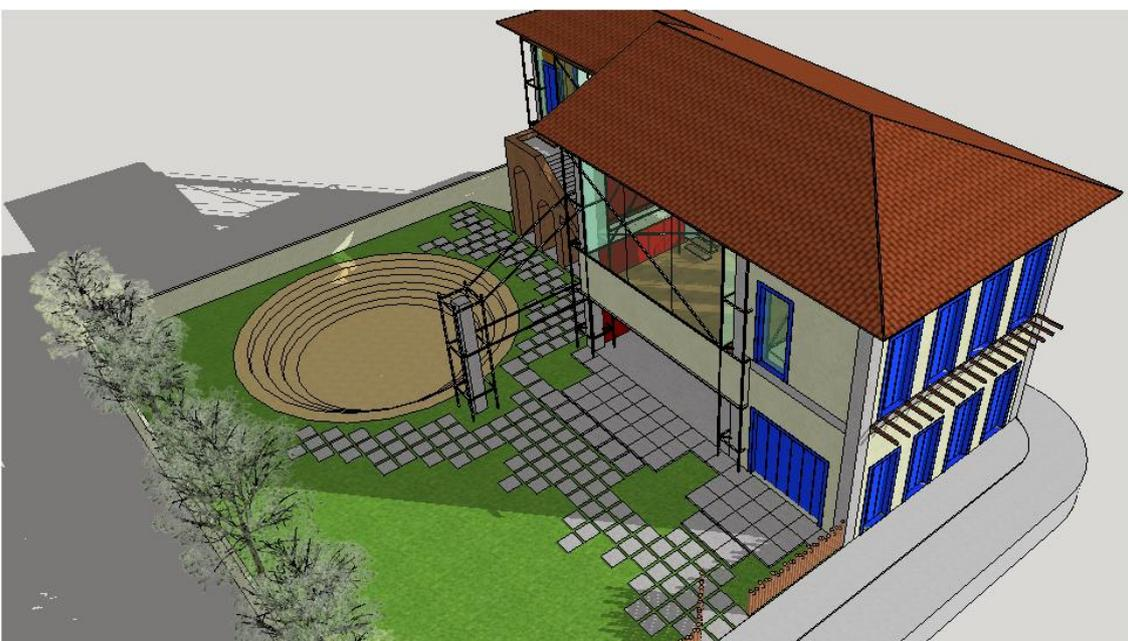
**Figura 57:** Estudo de Milton Santos de uma perspectiva aérea. Nota-se o anfiteatro para apresentações, a escada reformada, e, também, os pilares originais (sem muita intervenção) apoiados por uma estrutura metálica.
