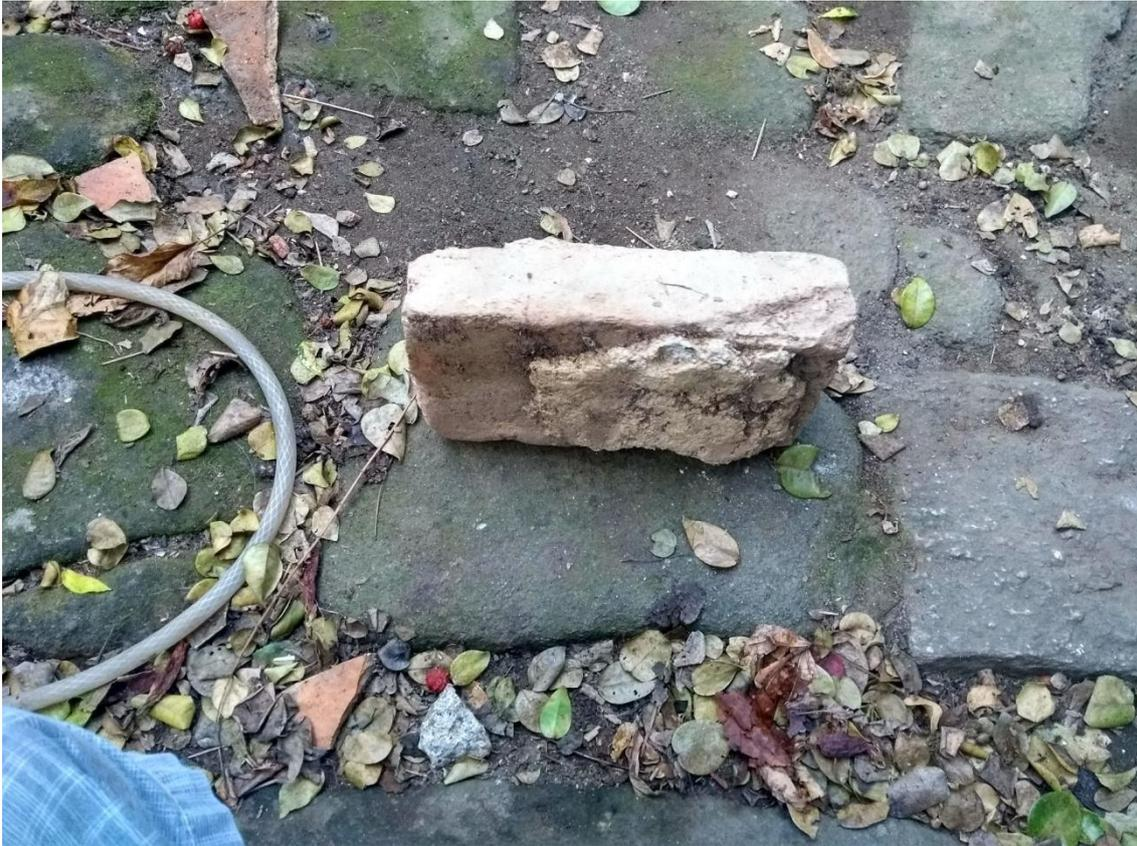
**Figura 72:** Tijolo original da casa com incrustações de argamassa, sobre o pavimento em pé de moleque. Foto autoral, 30/07/2019.
